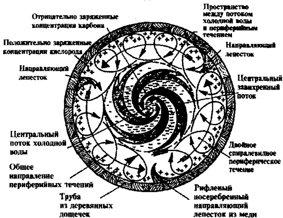
Рис. 16. Поперечный разрез трубы с двухпоточным спиралевидным течением 1
